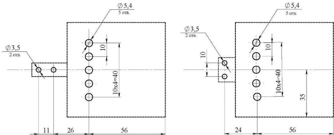
Рисунок Л.3 – Разметка отверстий для крепления УИР-03
