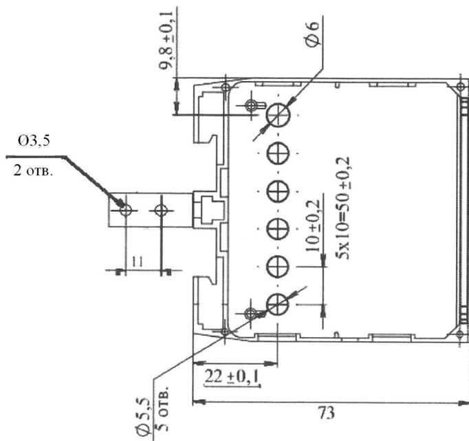
Рисунок Л.5 – Разметка отверстий для крепления УИР-04.01
