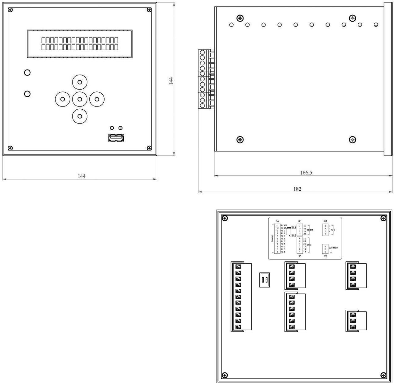
Рисунок А.6– Внешний вид и габаритные размеры ЦБ-03
