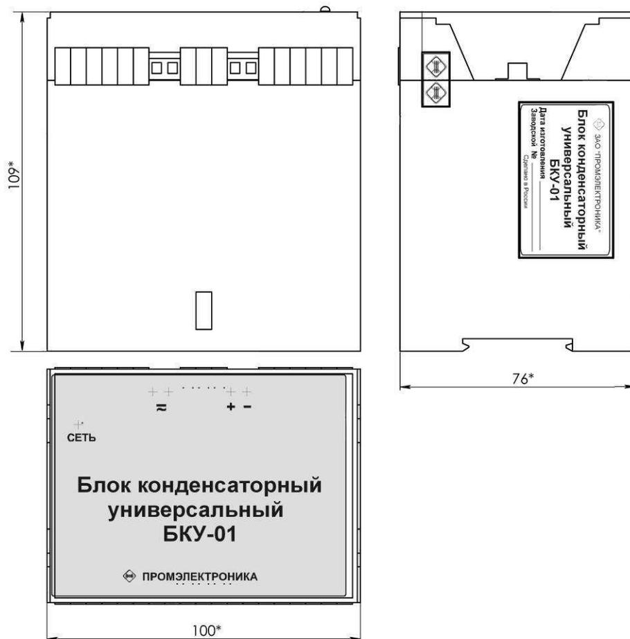
Рисунок А.7– Габаритные размеры БКУ-01
