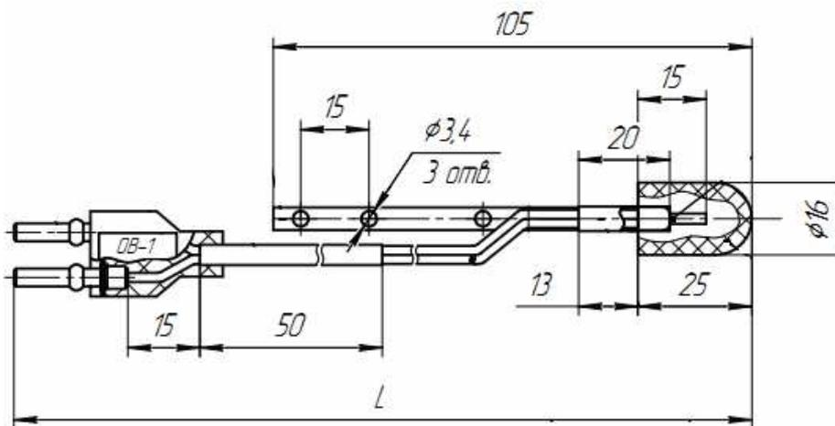
Рисунок А.2 – Габаритные и присоединительные размеры ОВ-1
