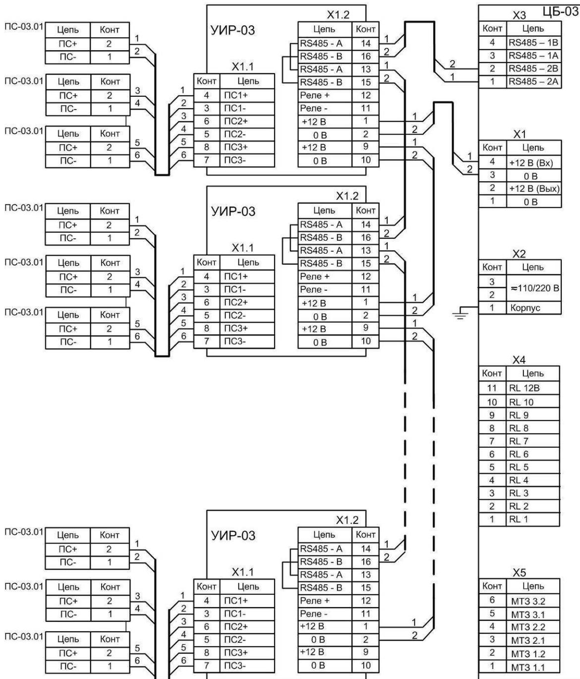
Рисунок М.1 – Типовая схема соединения блоков БССДЗ-03
