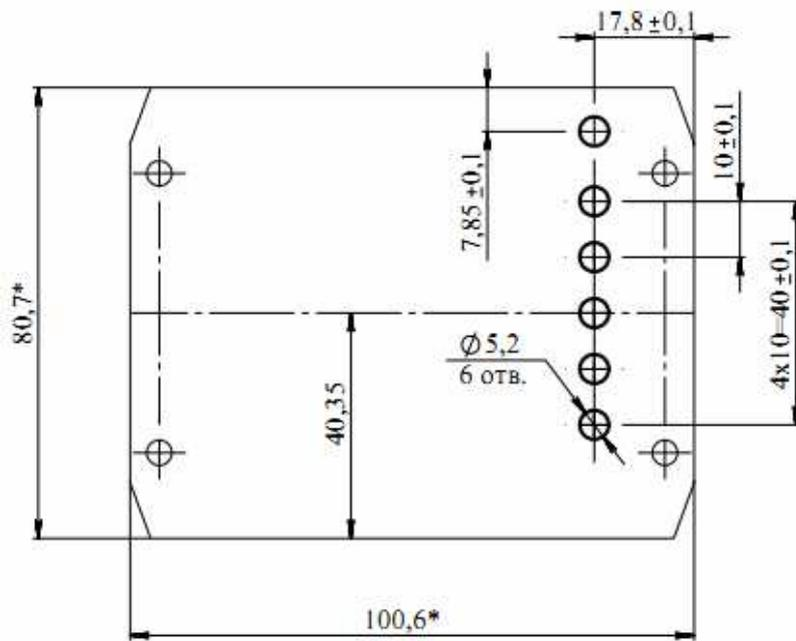
Рисунок Л.4 – Разметка отверстий для крепления УИР-04
