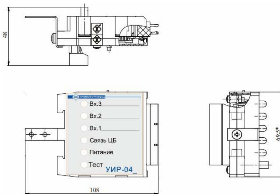
Рисунок А.5 – Внешний вид, габаритные размеры УИР-04.01
