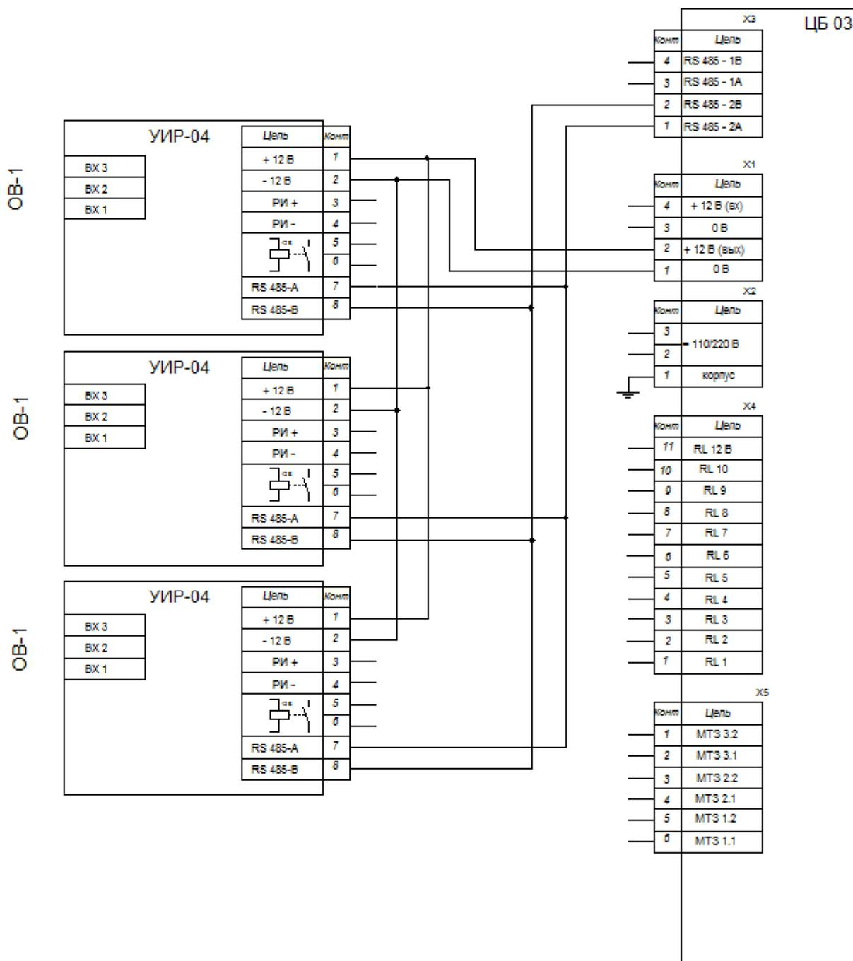
Рисунок М.2 – Типовая схема соединения блоков БССДЗ-03 с УИР-04
