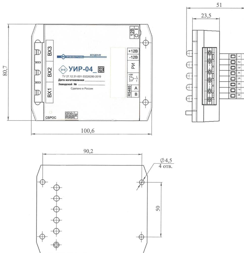
Рисунок А.4 – Внешний вид, габаритные размеры УИР-04
