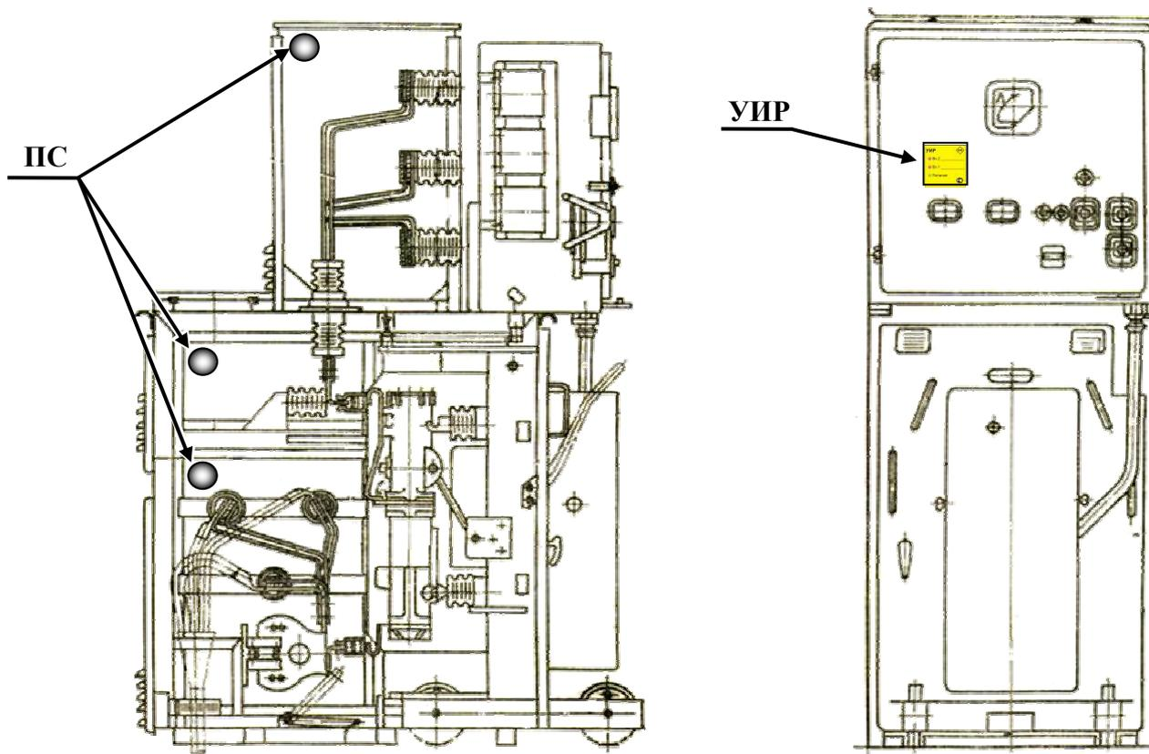
Рисунок В.1 – Пример размещения ПС (ОВ-1) и УИР в ячейке КРУ серии К-ХИ
