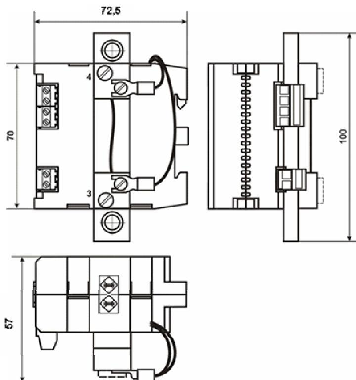
Рисунок А.8 – Внешний вид и габаритные размеры БК-02
