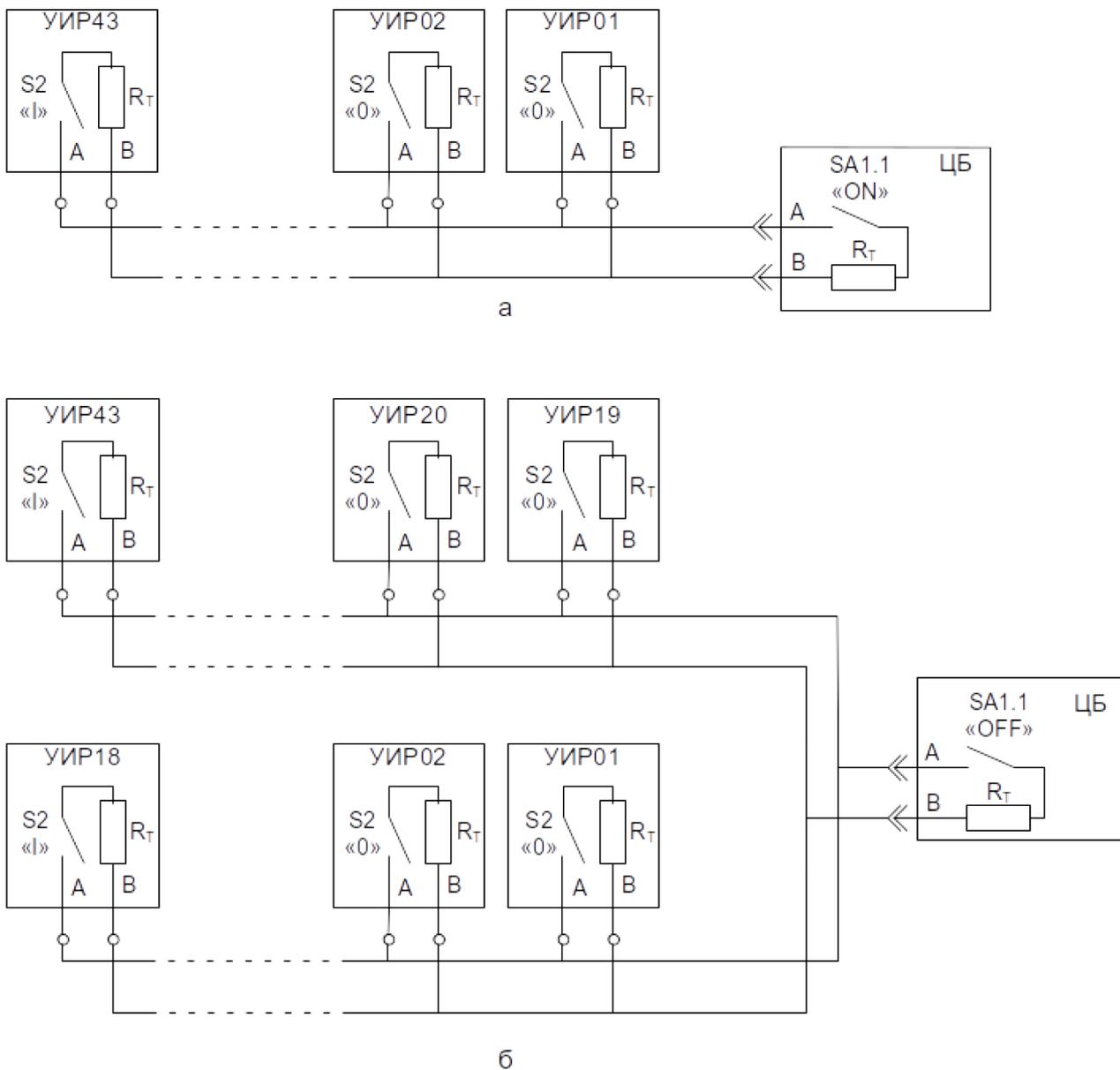
Рисунок Е.1 – Примеры включения терминальных резисторов на оконечных устройствах сети RS-485 ЦБ–УИР:
