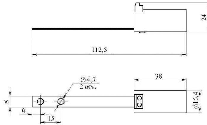
Рисунок А.1 – Габаритные и присоединительные размеры ПС
