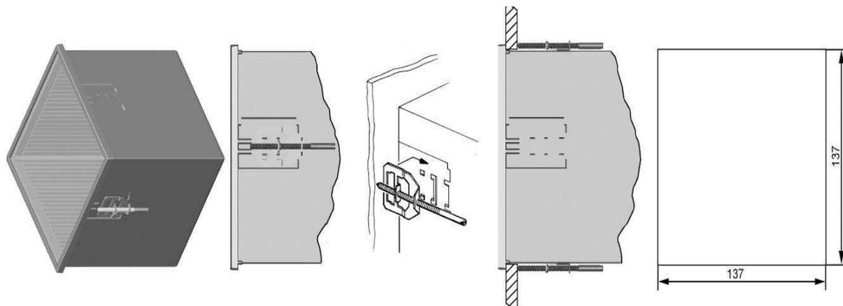
Рисунок Л.6 – Установка ЦБ (встроенный монтаж)
