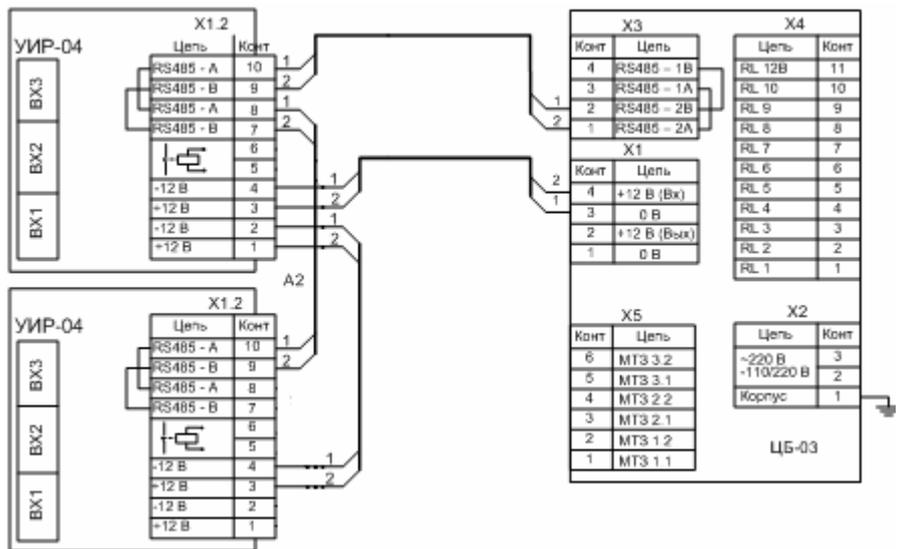
Рисунок М.3 – Типовая схема соединения блоков БССД3-03 с УИР-04.01
